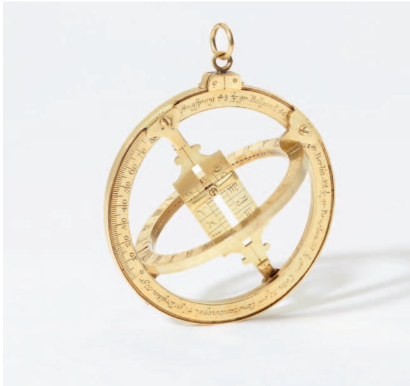
1172 Zweifache Ringsonnenuhr Messing, graviert, vergoldet. Meridianring und Äquaterring mit Stadtgravuren und Polhöhenangaben, Monatsschieber mit Tierkreiszeichen und Monatsgravuren. Nicht signiert. Ø 9,2 cm. Augsburg, zugeschrieben, 18. Jh. € 1 500 – 2 000
